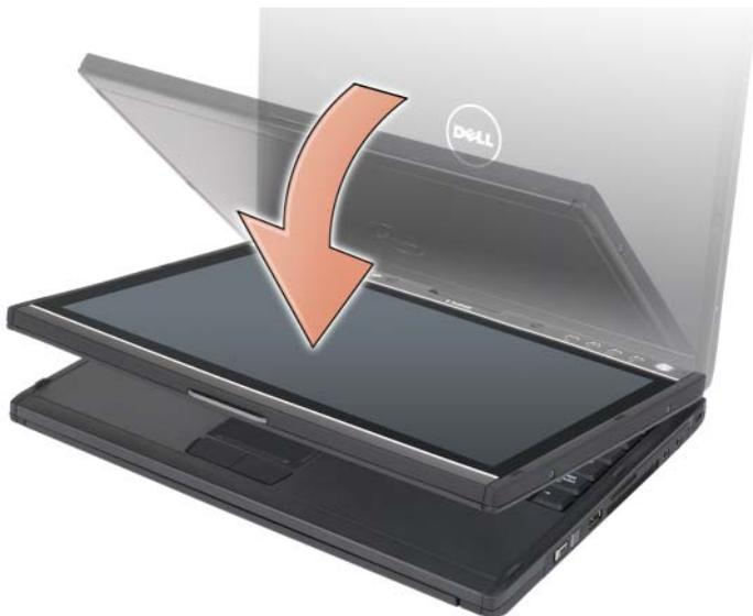
Tablet PC のノートブックモードとタブレットモードを切り替えると、Tablet PC の画面の向きは Dell QuickSet アプリケーションまたは Pen and Tablet settings（ペンとタブレットの設定）アプリケーションで指定した設定に従って自動的に変更されます。通常、横向き（ノートブックモード）から縦向き（タブレットモード）になります。Tablet PC 設定のカスタマイズの詳細に関しては、69 ページの「QuickSet」を参照してください。
