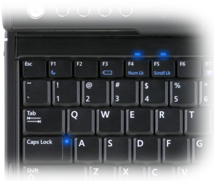
お使いの Tablet PC の 3 つのキーボードステータスライトは、対応するキーの組み合わせにより以下の機能がアクティブになっていることを示します。
